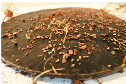
Obrázek č. 11: Demonstrace průběhu testování odolnosti proti prorůstání kořenů na BOKU (zdroj: autor, 2016)
