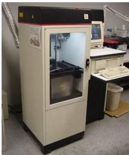
Obrázek 1. První SLA 3D tiskárna Apparatus z roku 1992 od společnosti 3D Systems Corp.
