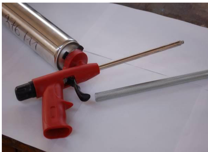
Obr. 72 Vybavení pro dodatečné kotvení ETICS. PU lepidlo s aplikační pistolí a kovová síťka ve tvaru válce.
