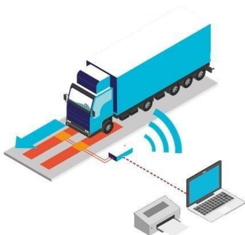
Obrázek 2: Princip vážení, Foto Tenzováhy
