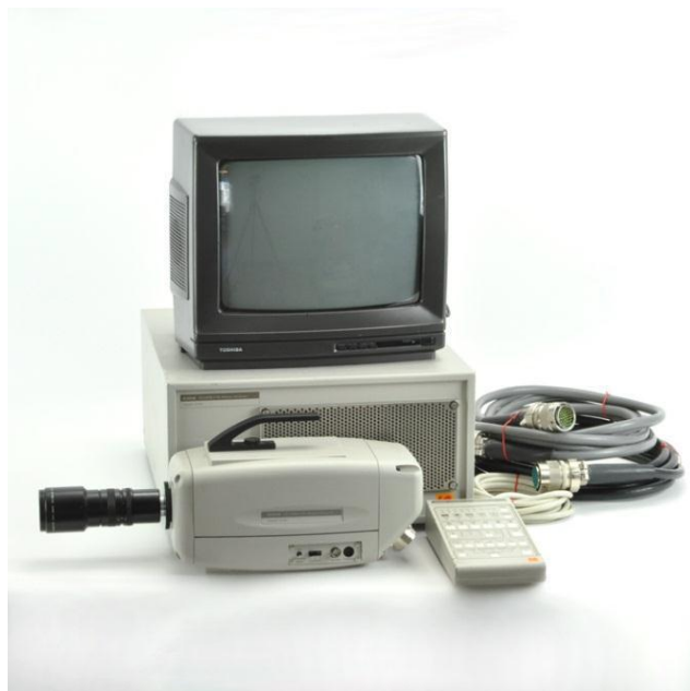
Obr 2-5 Vysokorychlostní kamera Kodak 4540 s příslušenstvím [10]
