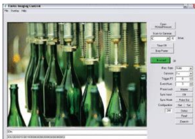
Obr 3-2 Snímek pořízený při snímání rychlé výrobní linky na zátkování lahví [13]
