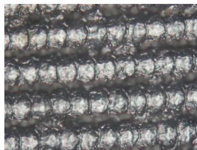
Obrázek 27 Úprava destiček C1 - s povlakem; 200x zvětšeno
