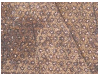
Obrázek 17 Úprava destičky 1H - bez povlaku; 200x zvětšení
