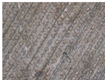
Obrázek 18 Úprava destičky 1H - s povlakem; 200x zvětšení
