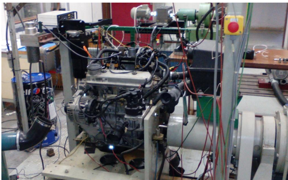
Obr.12 Motor Škoda umístěný na zkušebně
