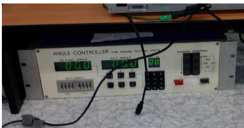
Obr.15 Modul pro ovládání servopohonu škrticí klapky
