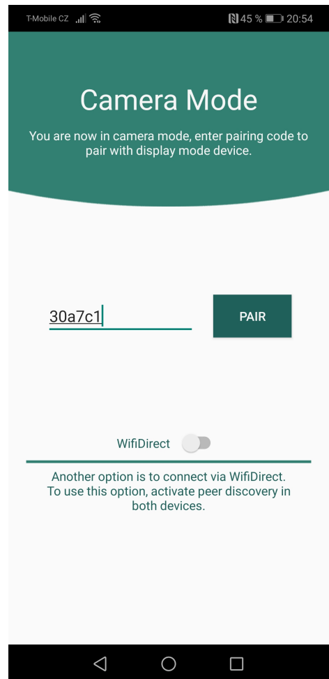
Obrázek 7.9: Na tomto obrázku je vidět hlavní obrazovka režimu kamera . Horní část obrazovky má popisnou funkci, vybízí uživatele k zadání párovacího kódu , který je generován v displejovém zařízení. Kód může být čtyřmístný pro jednorázové spojení nebo šestimístný pro dlouhodobé spojení. Ve spodní části obrazovky se nachází přepínač pro povolení vyhledávání zařízení prostřednictvím technologie Wi-Fi Direct – ukázka této varianty je na obrázku 7.10.
