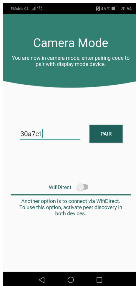
Obrázek 7.9: Na tomto obrázku je vidět hlavní obrazovka režimu kamera . Horní část obrazovky má popisnou funkci, vybízí uživatele k zadání párovacího kódu , který je generován v displejovém zařízení. Kód může být čtyřmístný pro jednorázové spojení nebo šestimístný pro dlouhodobé spojení. Ve spodní části obrazovky se nachází přepínač pro povolení vyhledávání zařízení prostřednictvím technologie Wi-Fi Direct – ukázka této varianty je na obrázku 7.10.
