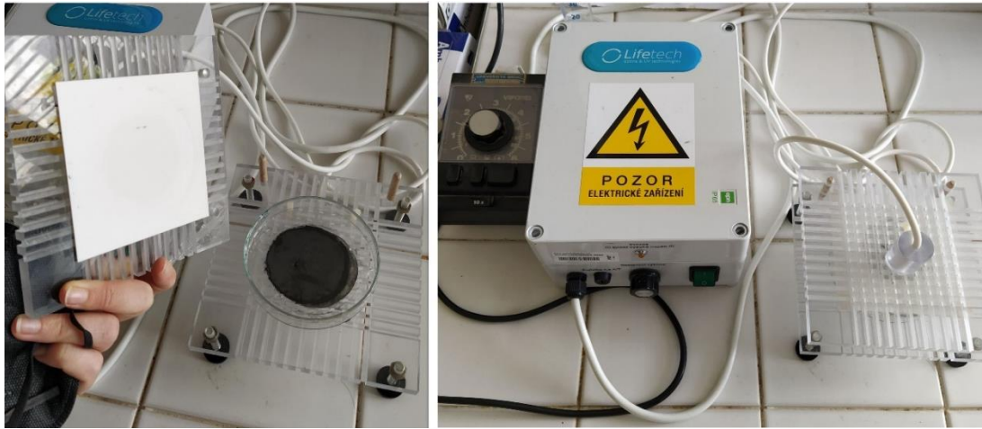
Obrázek 11: Reaktor pro přípravu plazmatem aktivované vody
