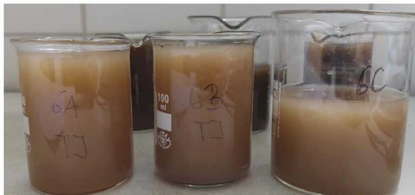
Obrázek 13: Kádinky s roztoky varianty č. 2 (vzorek A – destilovaná H_2O ; vzorek B – PAW; vzorek C – PAW + destilovaná H_2O )
