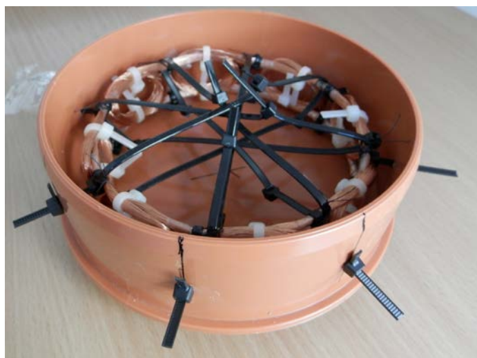
Obr. 47 Měřicí cívka před dotvarováním a zafixováním
