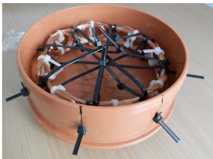
Obr. 47 Měřicí cívka před dotvarováním a zafixováním
