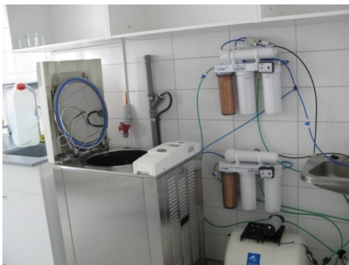
Obrázek 1 Sterilizátor 5075 ELV (Tuttnauer). Foto Petra Jiroutová
