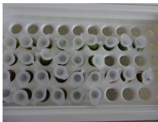
Obrázek 10 Ochlazení vzorků v ledové drti. Foto Dominika Dobrovolná
