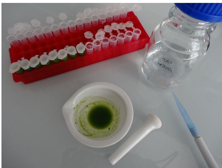
Obrázek 5 Homogenizace explantátů se 100% metanolem v třecí misce. Foto Dominika Dobrovolná
