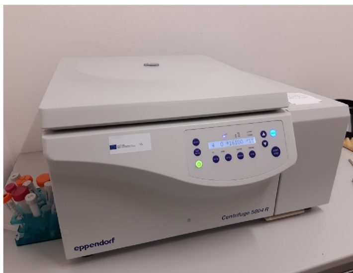
Obrázek 7 Chlazená centrifuga Eppendorf 5804 R, Německo. Foto Zuzana Kovalíková
