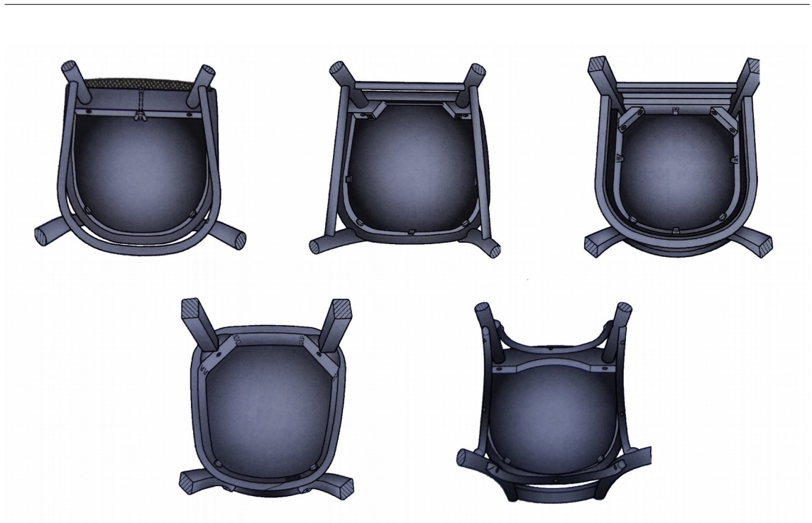
Obr. 15: Způsoby napojení nohou na luby
