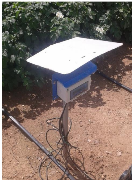
Příloha č. 4. – Aplikátor kapalného hnojiva + řídicí jednotka k dávkování závlahové vody
