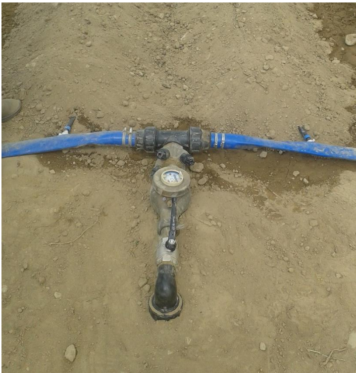
Příloha č. 4. – Aplikátor kapalného hnojiva + řídicí jednotka k dávkování závlahové vody
