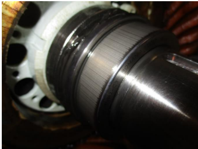
Obrázek 6.11 Foto poškozeného ložiska motoru TAM1020CA
