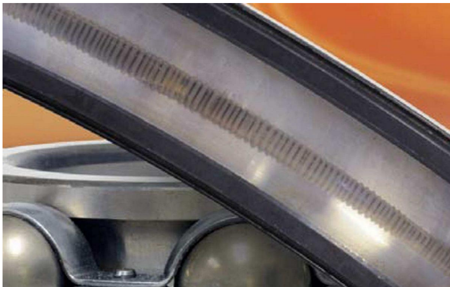
Obrázek 1.1 Poškození povrchu ložiska v důsledku ložiskových proudů [1]
