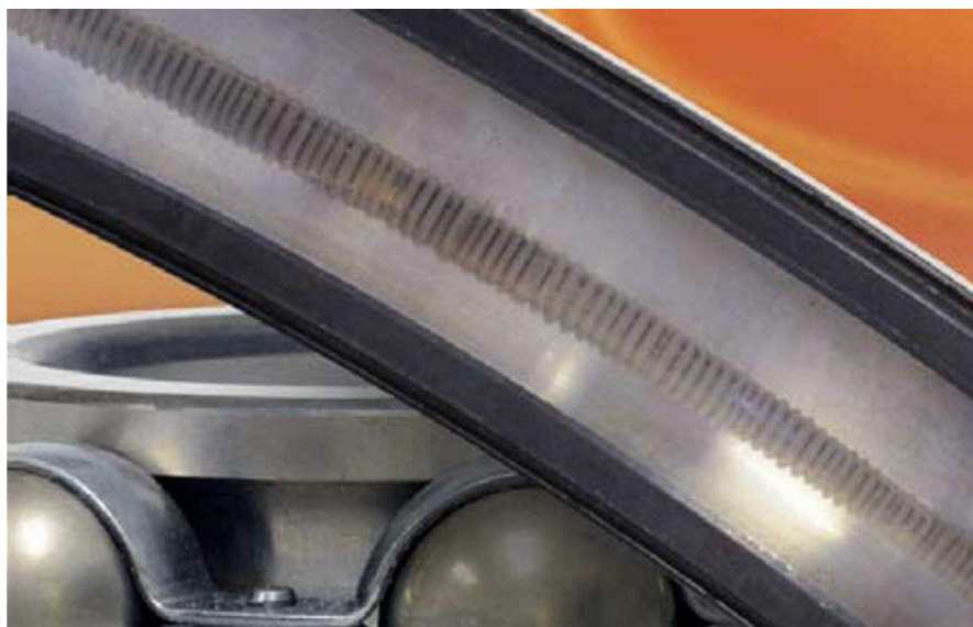
Obrázek 1.1 Poškození povrchu ložiska v důsledku ložiskových proudů [1]
