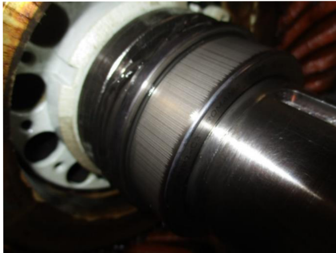
6.11 Foto poškozeného ložiska motoru TAM1020CA
