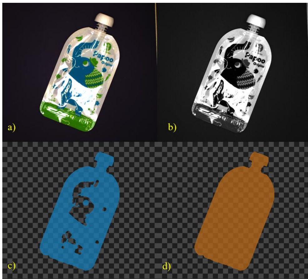
Obr. 60 a) původní snímek, b) převedení RGB snímku na černobílý, c) výsledný region po ExtractBlobs: Intensity , d) region po vyplnění děr funkcí FillRegionHoles
