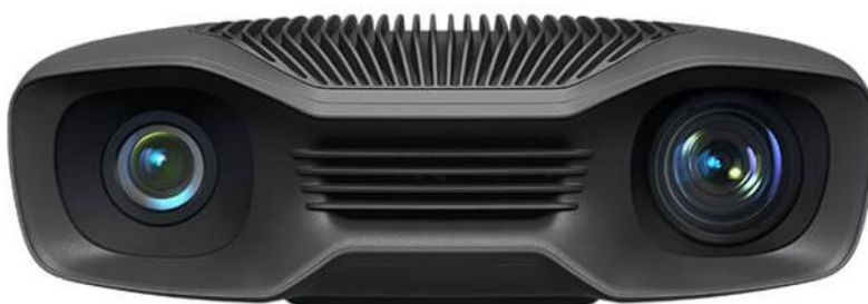
Obr. 40 Zivid two , kompletní zařízení pro strojové vidění ve 3D [25]
