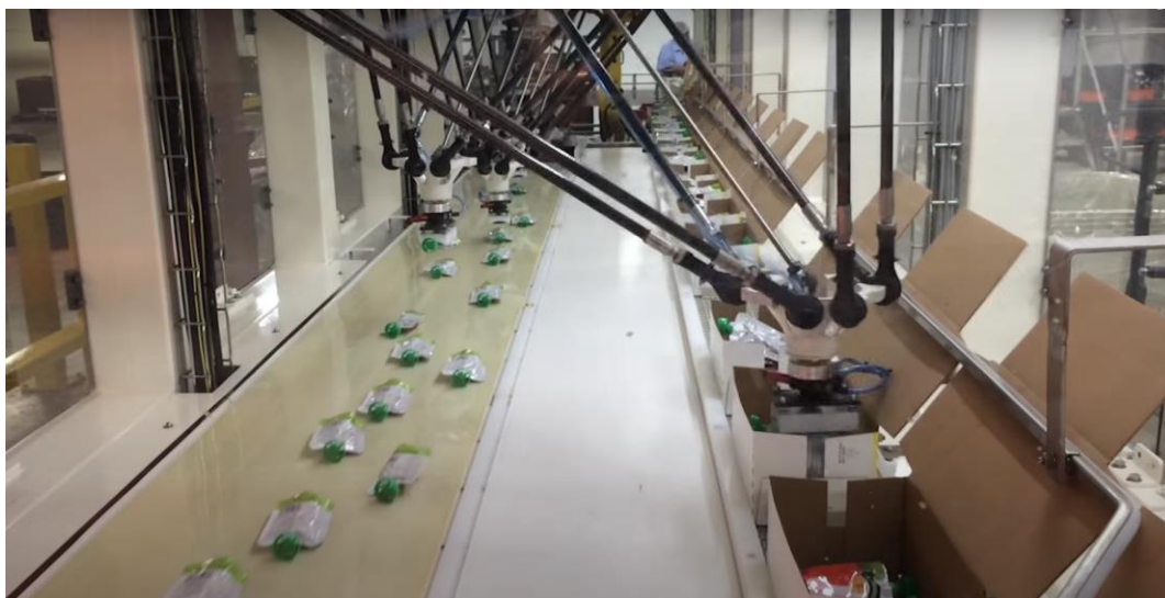
Obr. 35 2D lokalizace objektů na dopravníkovém pásu a robotická manipulace do krabic [20]
