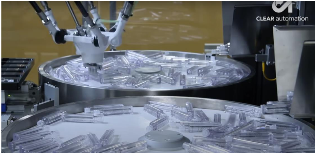
Obr. 36 2D picking pomocí dvou Flexibowl ® zásobníků, delta robotu a 2D kamerového systému [21]
