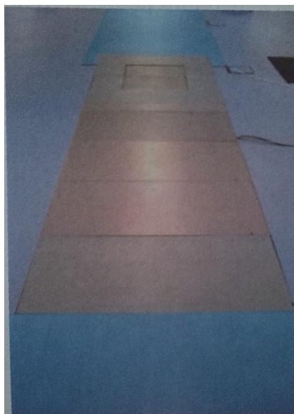
Obrázek 6. Dvě silové plošiny zabudované v podlaze (Jandačka, 2011)
