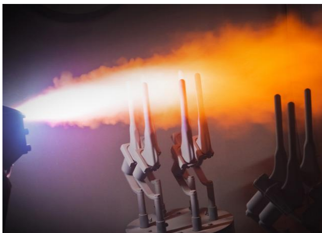
Obr. 23 Plazmou nanášený HA povlak na kovové implantáty [10]
