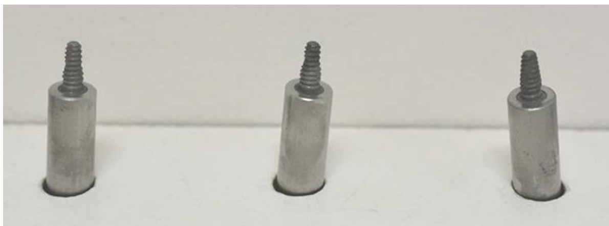
Obr. 30 Otryskané vzorky dentálních implantátů
