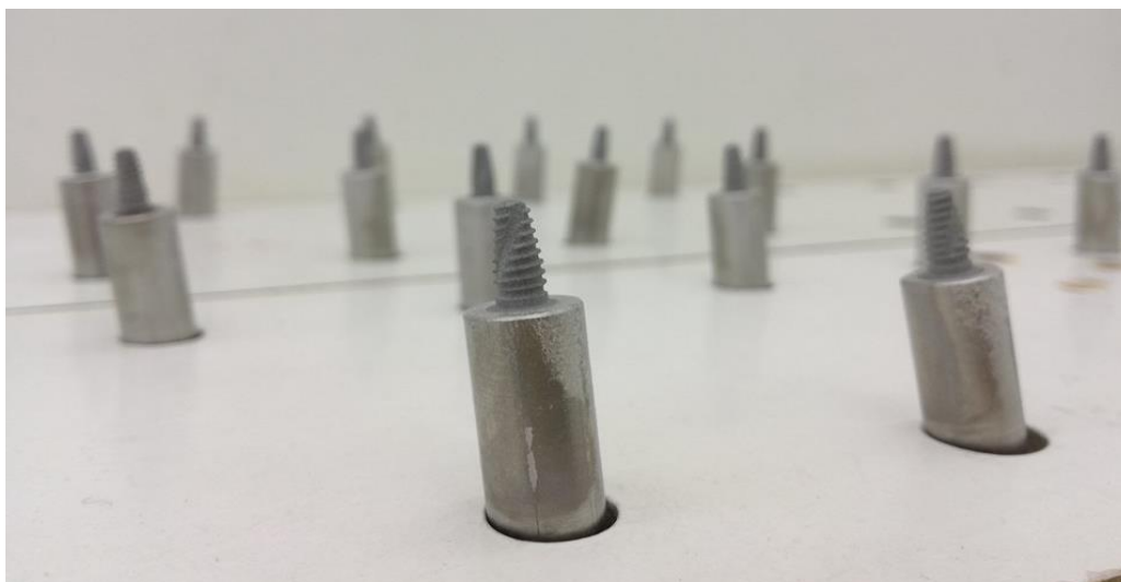
Obr. 37 Implantát nastříkaný hydroxyapatitovým práškem
