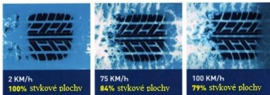
Obr. 14 Projev aquaplaningu u nové pneumatiky [18]
