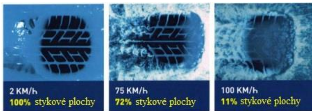
Obr. 19 Projev aquaplaningu u pneumatiky s ojetým dezénem [18]
