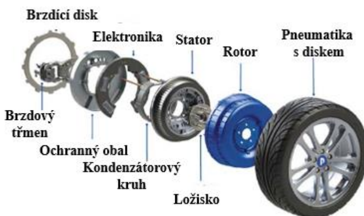
Obrázek 7 Rozpad elektromotoru uvnitř kola
