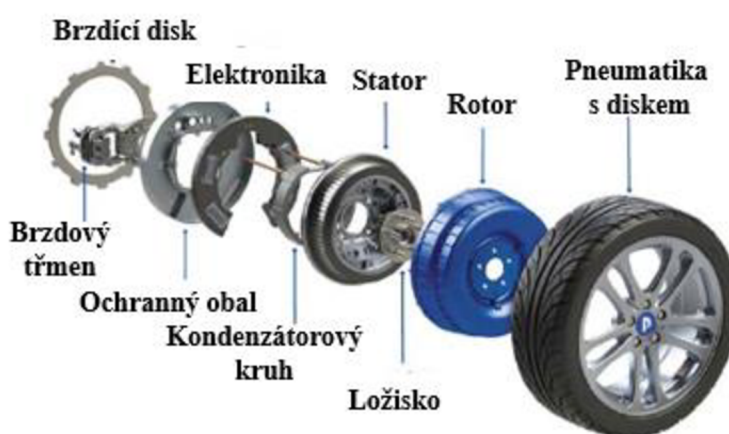
Obrázek 7 Rozpad elektromotoru uvnitř kola
