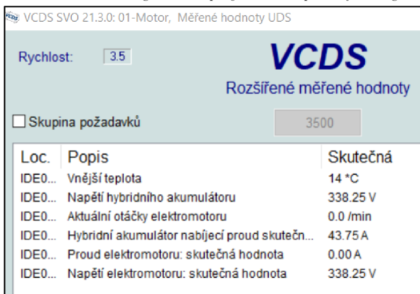
Obrázek 20 Rozhraní diagnostického programu VCDS při nabíjení Citigo IV
