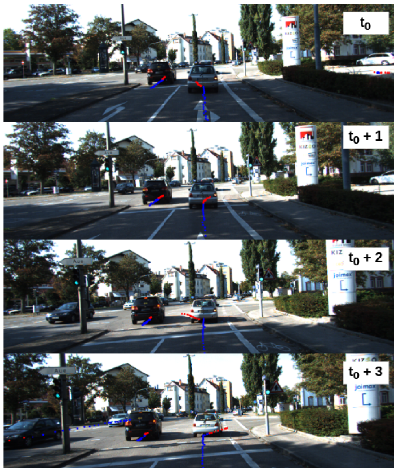
Obr. 4.2: Vizualizácia nekonzistentných výsledkov predikcie. Pre snímky idúce v poradí bezprostredne za sebou je vidieť nekonzistentné a meniace sa predikcie trajektórie vozidla odbočujúceho vpravo.
