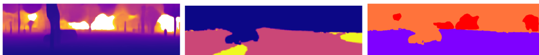
Obr. 3.4: Výsledok prieniku filtrovanej hĺbkovej a sémantickej mapy. Posledný obrázok zobrazuje, pozície pixelov, ktoré budú použité na vytváranie pointcloudu. Pixely na pozíciách červenej a oranžovej farby budú ignorované. Pixely fialovej farby sú prítomné v sémantickej aj hĺbkovej mape, a preto sú zachované.
