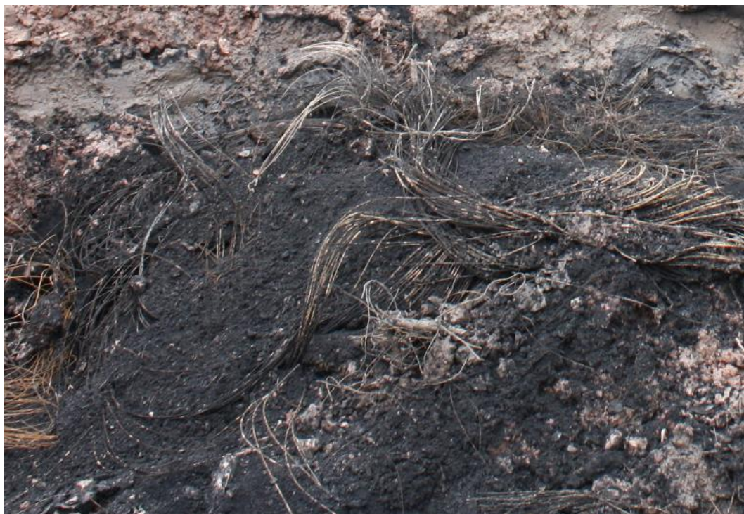
Obr. 63: Spálená pneumatika, vz. č. 1
