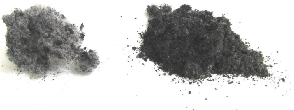
Obr. 34: Vzorky směsi nylon-pryž I a II
