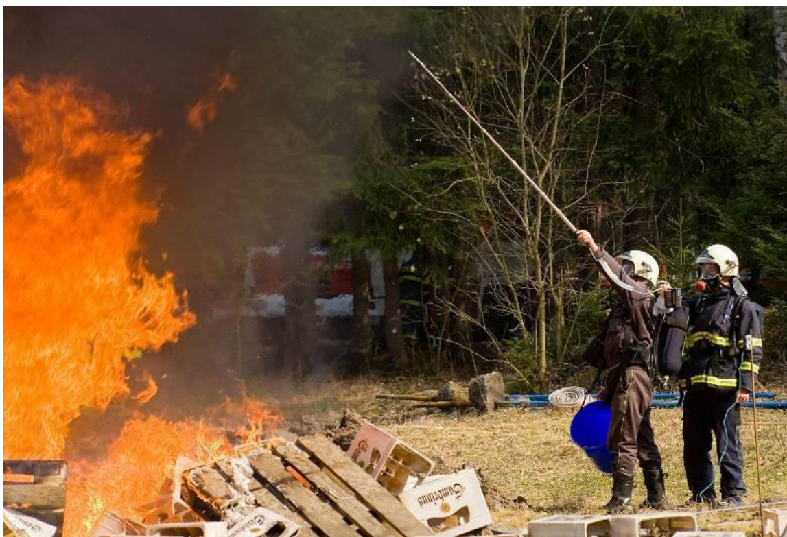
Obr. 44: Odběr plyných zplodin do tedlarových vaků [54]
