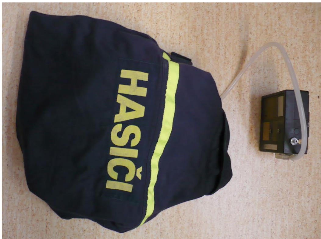
Obr. 76: Odběr látek uvolňovaných z textilie na tenaxovou sorpční trubičku
