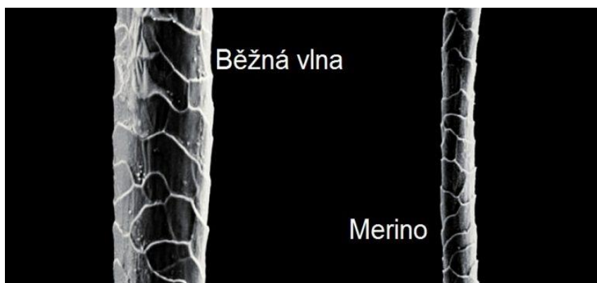
Obrázek 3: Porovnání běžného vlněného vlákna s Merino vláknem [20]
