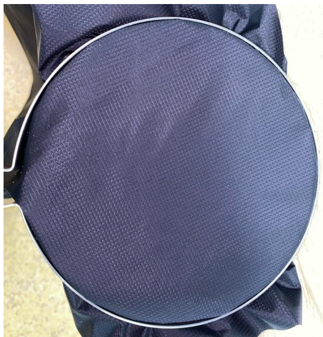
Obrázek 13: Spray-test na laminátu B
