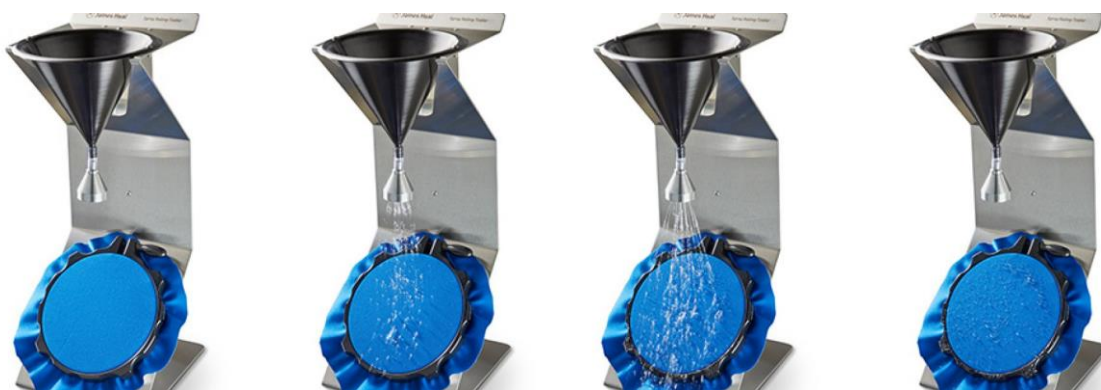
Obrázek 2: aparatura spray testu [14]
