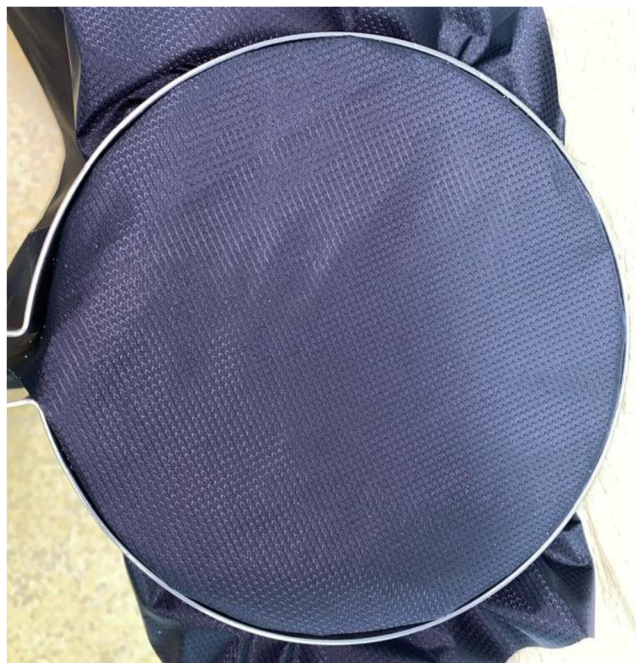
Obrázek 13: Spray-test na laminátu B
