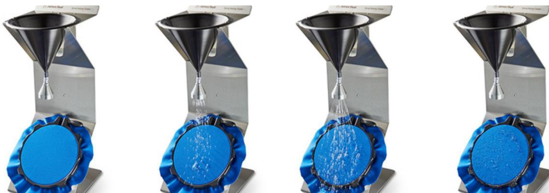
Obrázek 2: aparatura spray testu [14]
