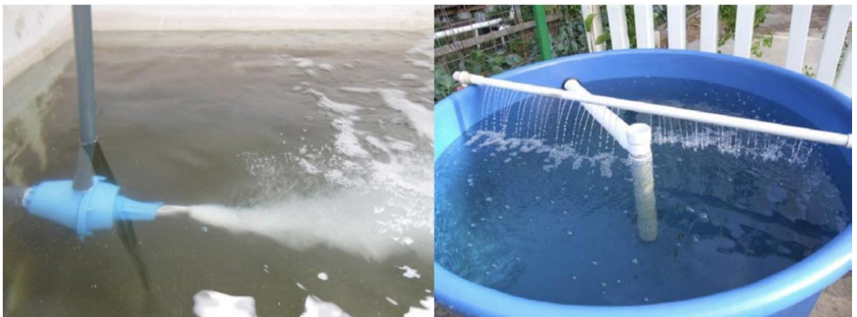
Obrázek 9 Vlevo - venturiho trubice použitá pro aeraci, vpravo- rozstřík vody na hladinu pro aeraci (Chromý 2023)
