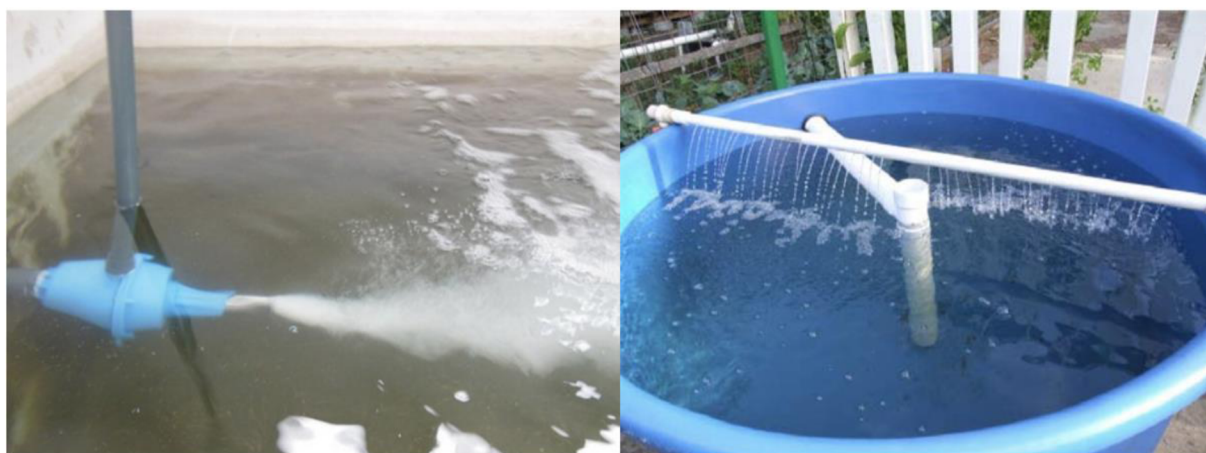
Obrázek 9 Vlevo - venturiho trubice použita pro aeraci, vpravo- rozstřík vody na hladinu pro aeraci (Chromý 2023)
