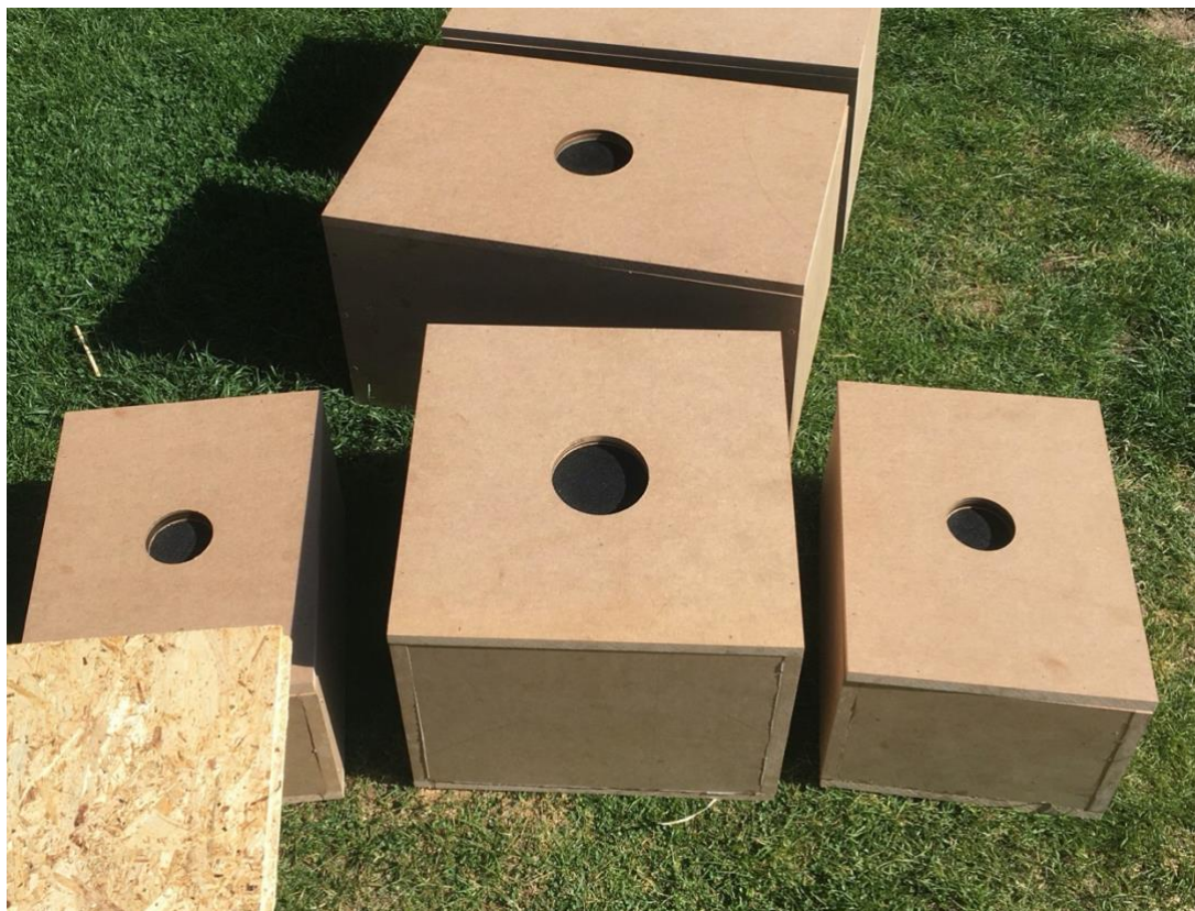
Obr. 3.7: Sestrojené Helmholtzovy rezonátory
