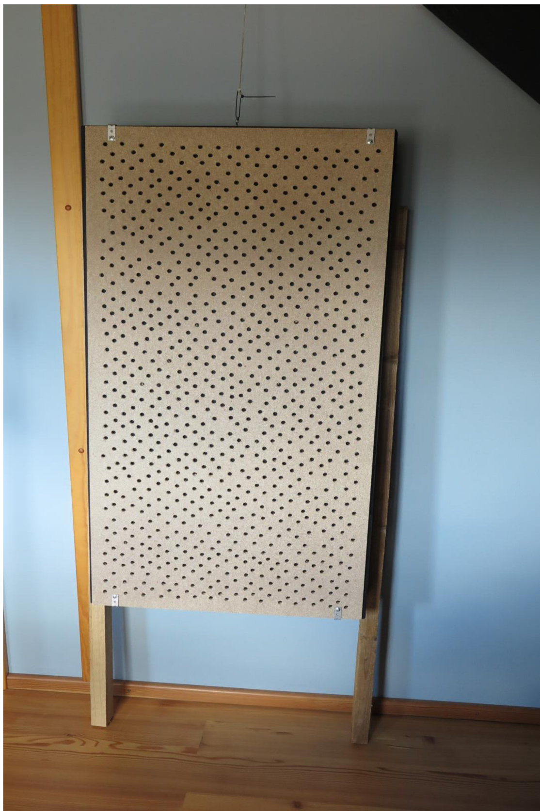
Obr. 3.6: Zkonstruovaný perforovaný panel.
