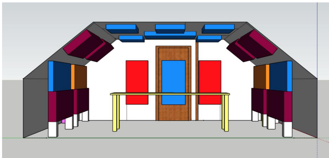
Obr. 3.2 Rozmístění akustických prvků v místnosti.
