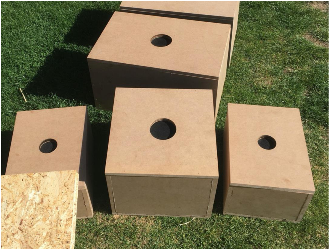
Obr. 3.7: Sestrojené Helmholtzovy rezonátory
