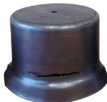
b) trhlina v přechodu ploch
