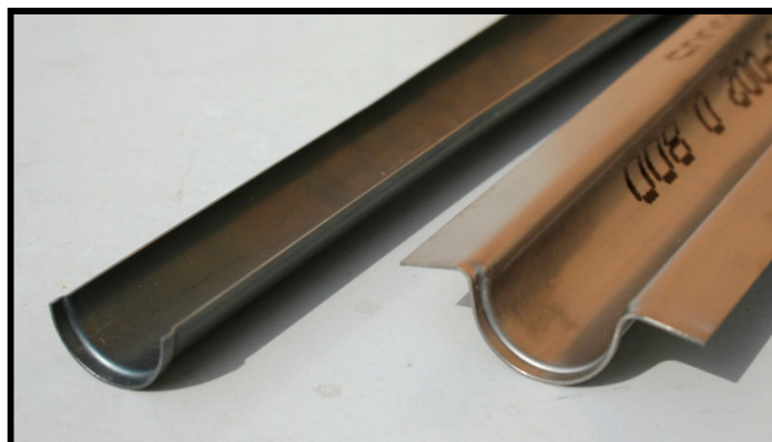
Obr. 3.19 Obrobený titánový diel vnútorného kužeľa.
