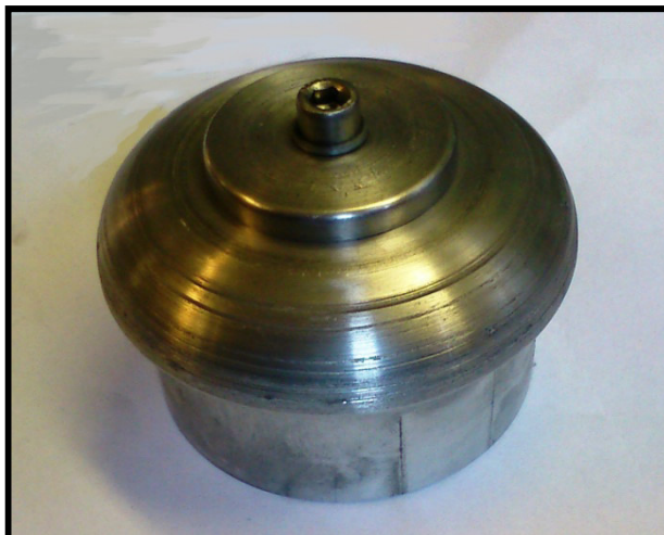
Obr. 3.9 Upínací prípravok na sústruženie odrazového veka.
