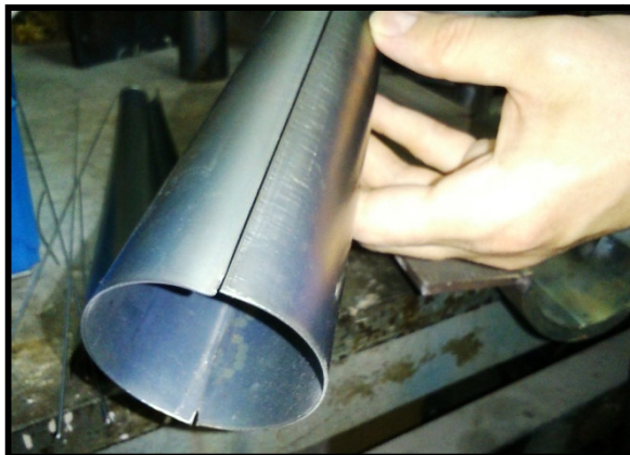
Obr. 3.22 Kuželové polotovary pred zvarením
