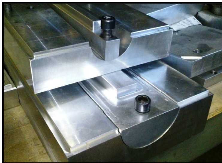
Obr. 3.18 Frézovací prípravok pre vnútorný kužeľ (hore) a vonkajší kužeľ (dole).
