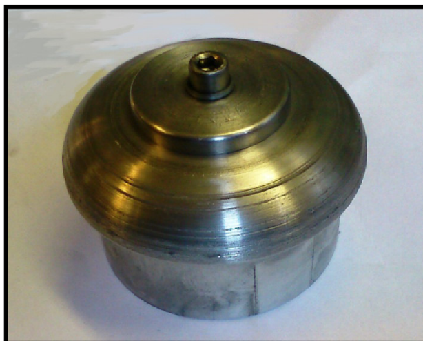
Obr. 3.9 Upínací prípravok na sústruženie odrazového veka.
