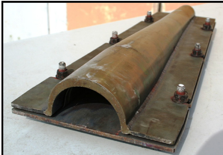
Obr. 3.15 Napínací prípravok pre tepelné spracovanie na vonkajší kužeľ.
