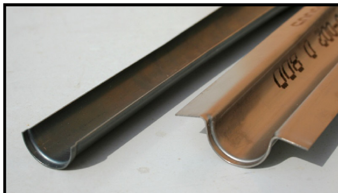
Obr. 3.19 Obrobený titánový diel vnútorného kužeľa.
