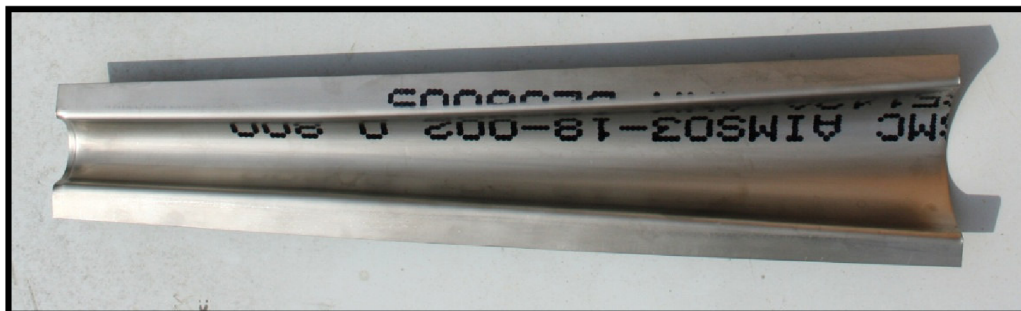
Obr. 4.6 Diel vnútorného kužeľa po ohybe.
