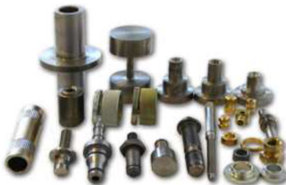
Obr. 1: Příklady součástí vyrobených objemovým tvářením [2]
