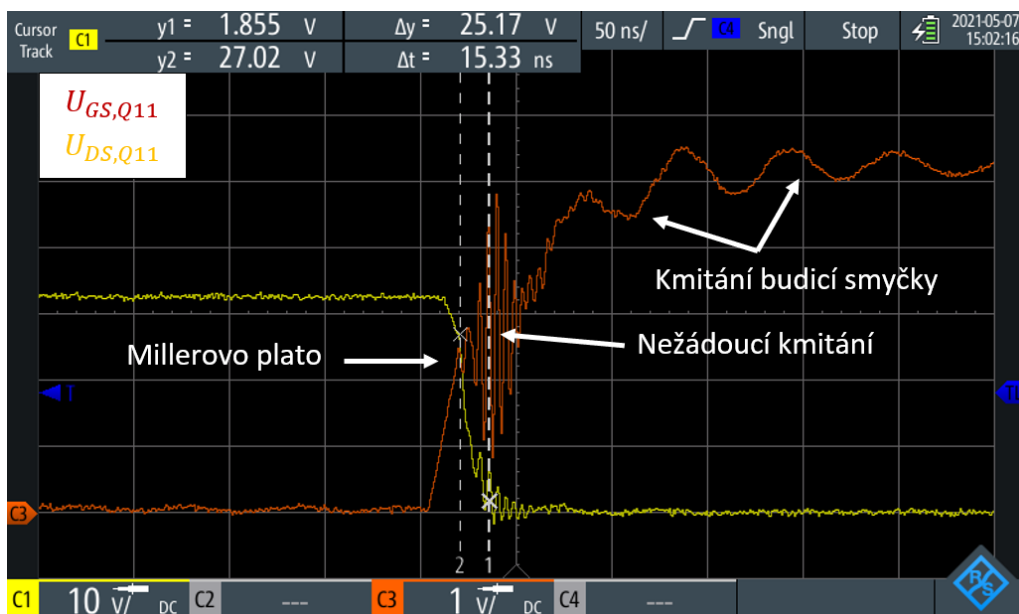
Obr. 8.11: Detail zapnutí tranzistoru Q11
