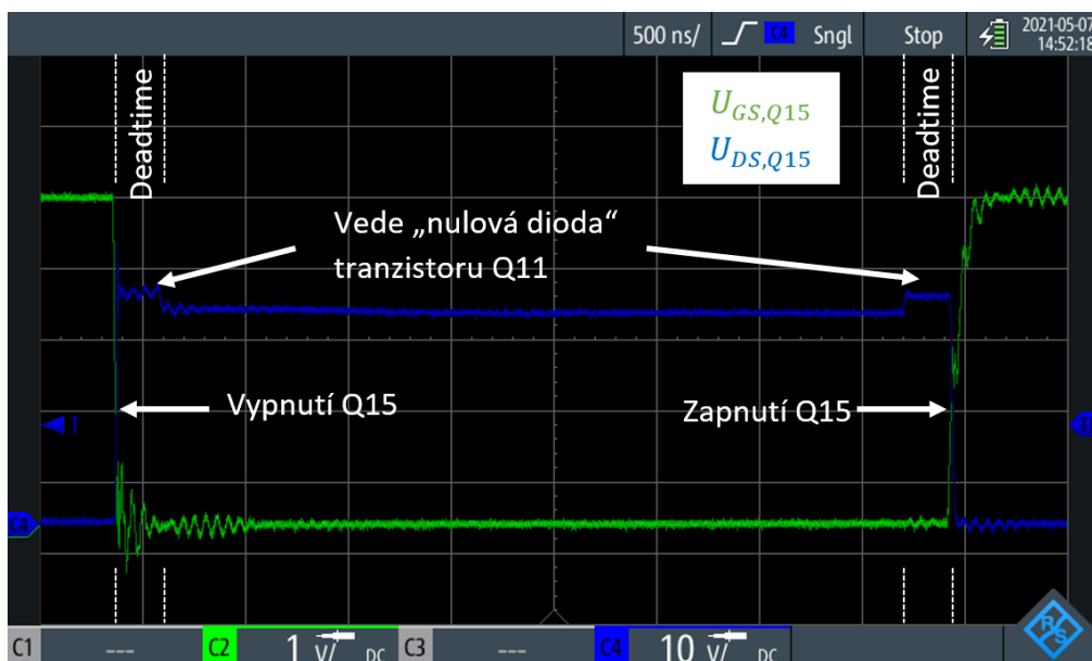
Obr. 8.10: Zapnutí a vypnutí tranzistoru Q15
