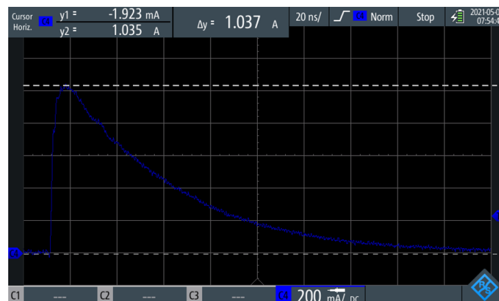
Obr. 8.4: Průběh zapínacího proudu na hradle horního tranzistoru Q11
