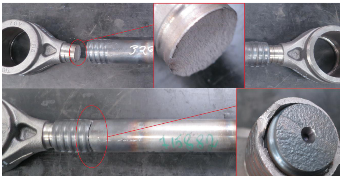
Obr. 50 Příkladů únavových lomů táhel (na dřívku-neplatný; na trubce)
