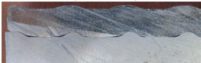
Obr. 28 Detail nedokonalostí dolisování
