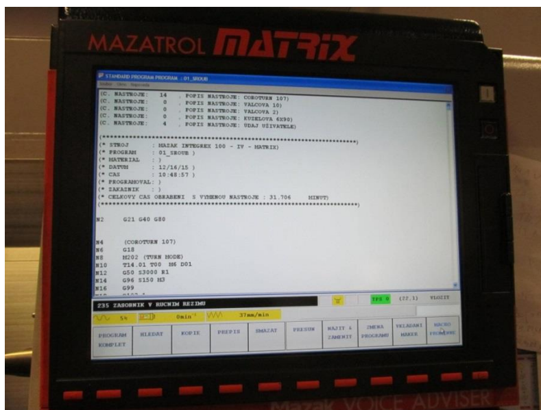
Obrázek 22 NC program na obrazovce stroje
