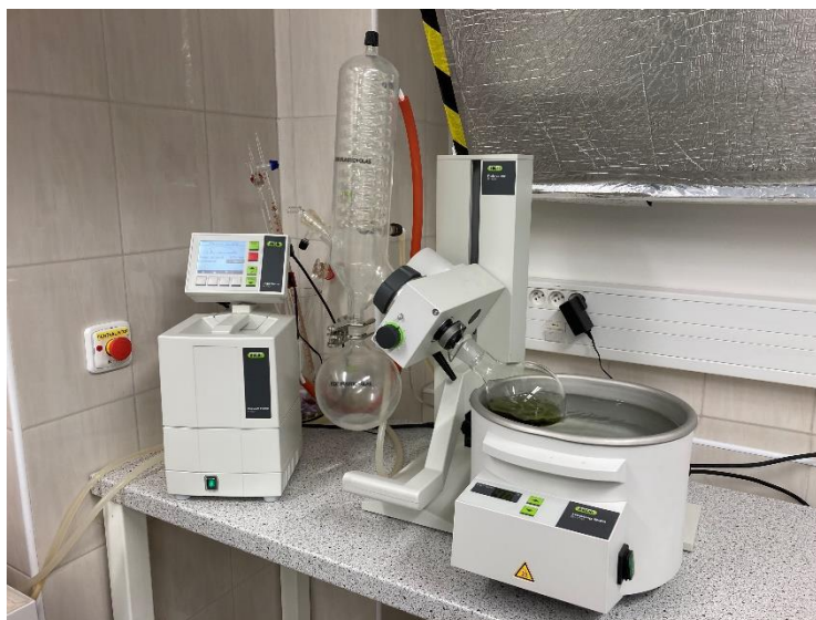
Obrázek 21 - Jednoduchá rotační vakuová odparka. Foto: autor
