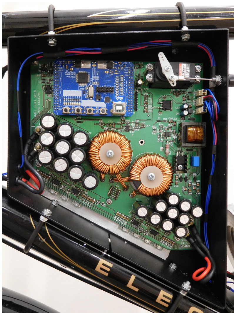
Obr. H.1: Kompletní měnič umístěný v navržené krabici
