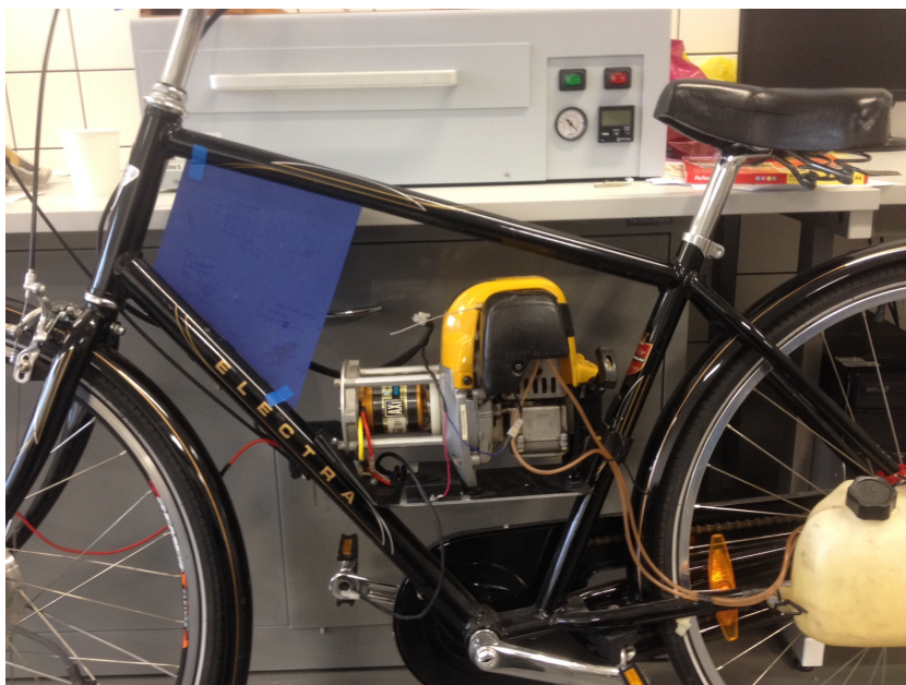
Obr. 1.1: Výchozí podoba elektrokola se znázorněním umístění měniče
