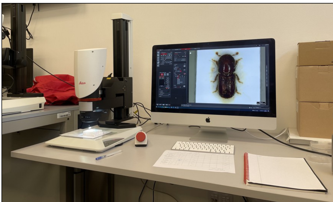
Obr. č. 22 – Digitální mikroskop Leica DVM6 se softwarem LAS X (foto autor)
