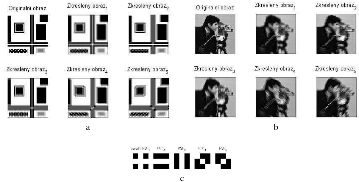
Obrázek 4.1: Originální obraz před a po zkreslení pěti různými PSF (uměle vytvořený obraz (a), obraz reálného objektu (b), zkreslující PSF (c))
