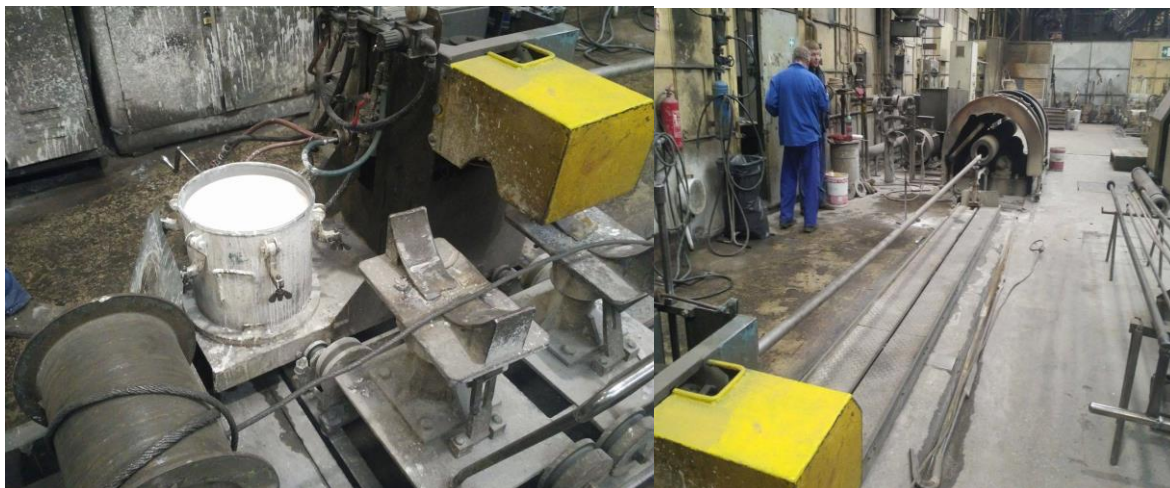
Obr.21 a 22: Žáruvzdorná směs nanášená do rotující kokily
