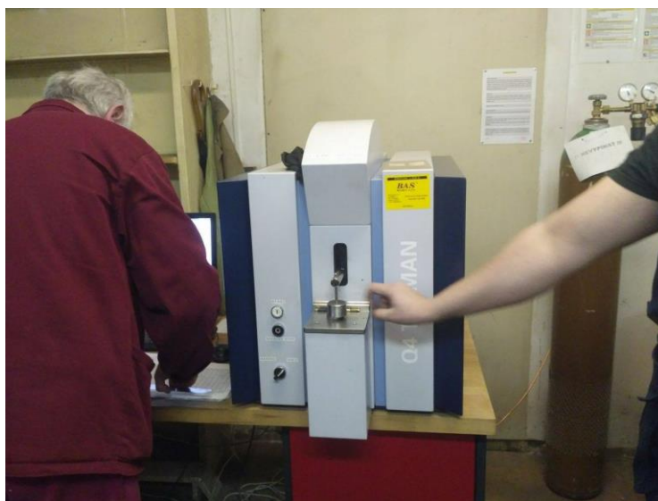
Obr.19: Metalurgická zkouška odlitého kovu pro zjištění chemického složení
