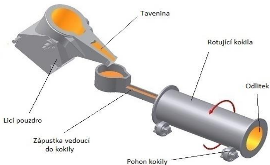
Obr.5: Horizontální odstředivé lití [25]
