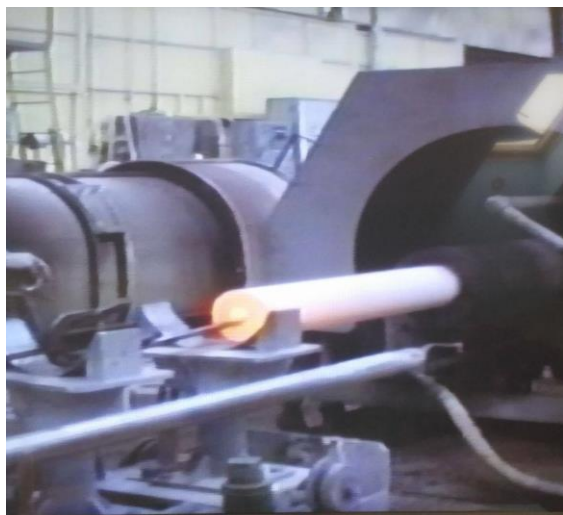
Obr.31: Vytážení ztuhlé trubky ze stroje [17]
