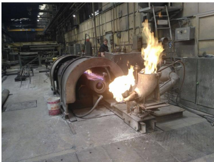
Obr.20: Nahřátí formy a nálevky
