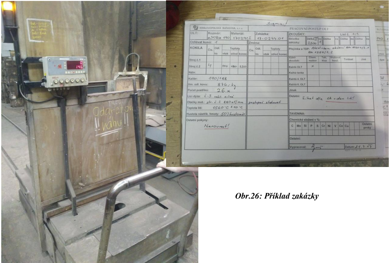
Obr.25: Vozík s váhou pro převezení lící pánve
