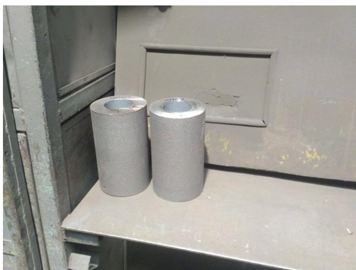
Obr.36: Nařezaná trubka na požadovanou délku
