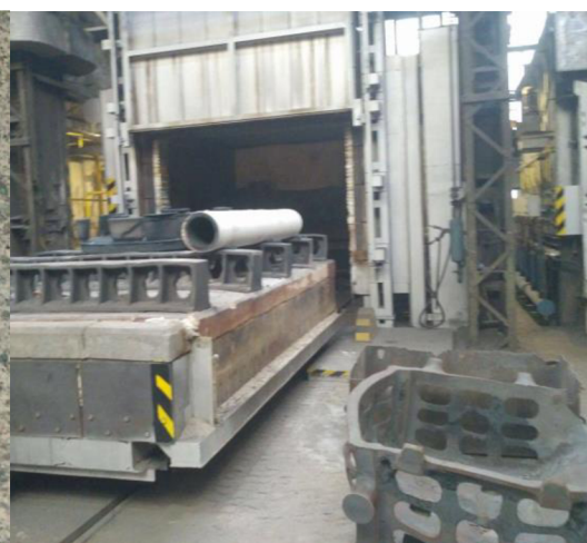
Obr.34: Odlitá trubka zajiždí do žíhací pece
