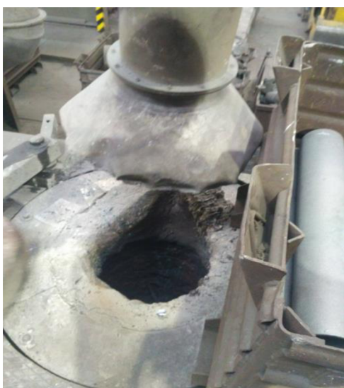
Obr.17 a 18: Indukční pec pro roztavení kovu
