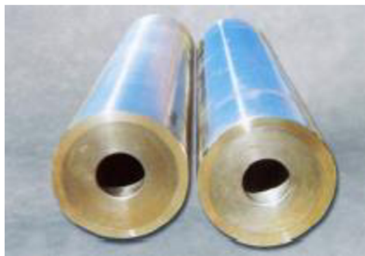
Obr.44: Dvouvrstvé mlecí válce (vnější vrstva z tvrdé, vnitřní vrstva z šedé litiny) [20]
