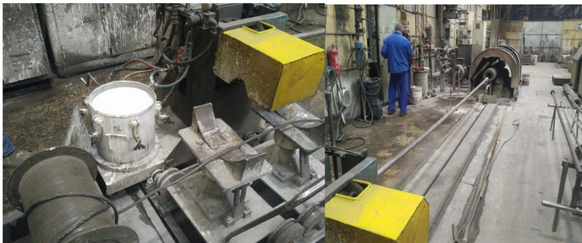
Obr.21 a 22: Žáruvzdorná směs nanášená do rotující kokily
