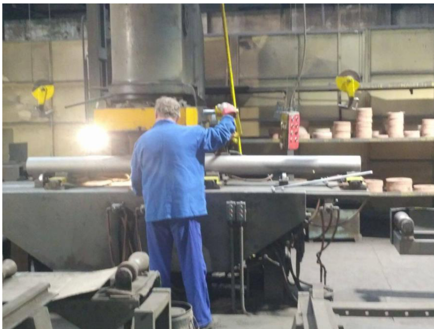
Obr.35: Kontrolor narovnává mírně zdeformované trubky
