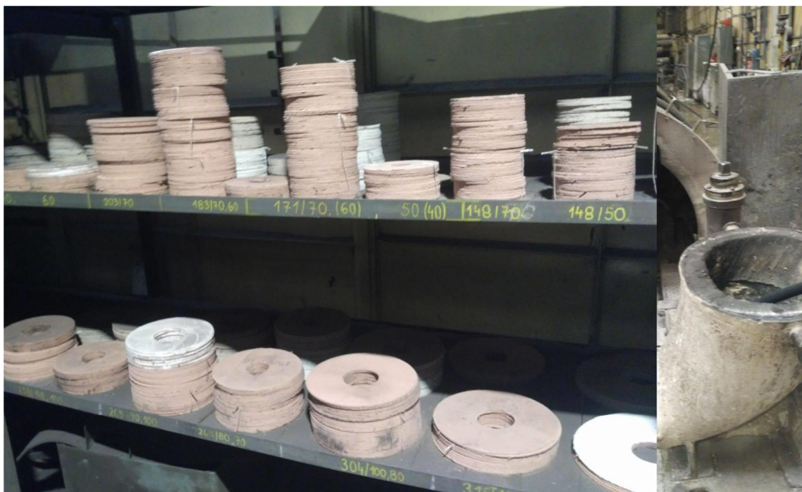
Obr.23 a 24: Různá těsnění pro různé kovy k utěsnění kokily
