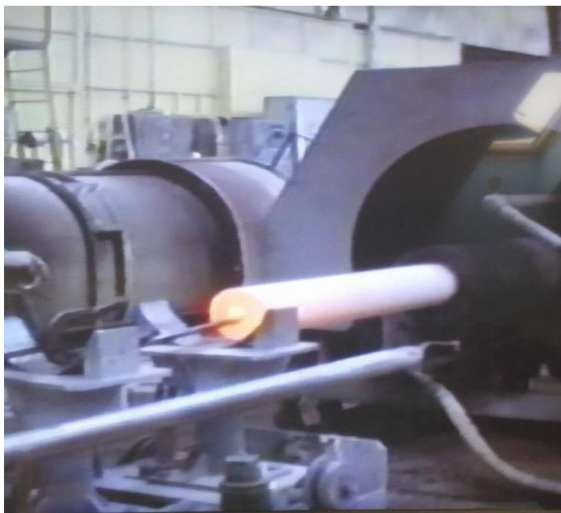
Obr.31: Vytažení ztuhlé trubky ze stroje [17]
