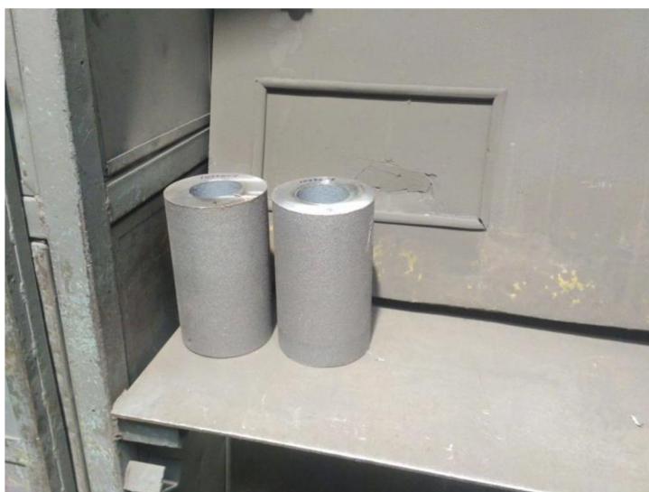
Obr.36: Nařezaná trubka na požadovanou délku
