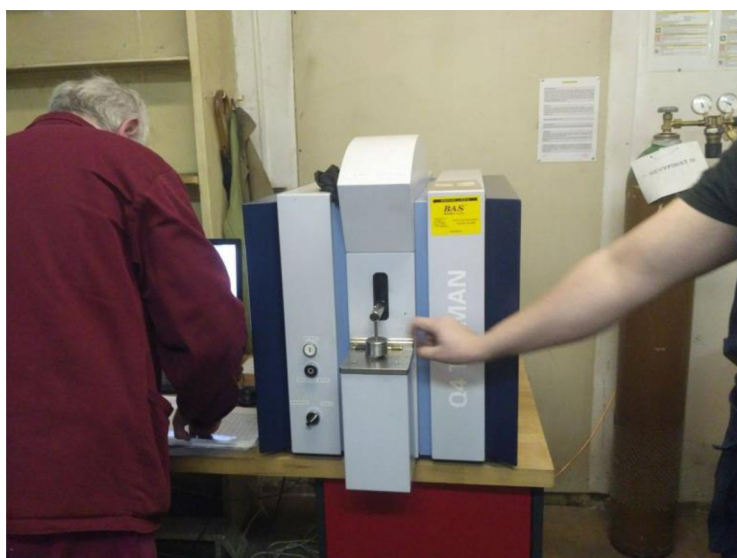
Obr.19: Metalurgická zkouška odlitého kovu pro zjištění chemického složení
