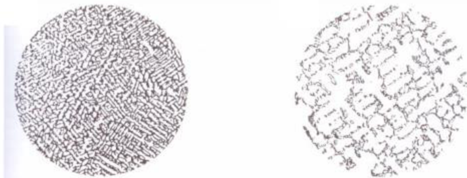
Obr.42: Struktura oceli odstředivě odlité (vlevo) a gravitačně odlité (vpravo) [13]
