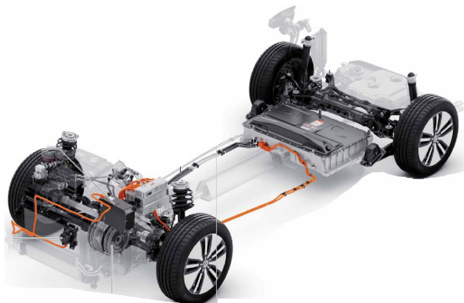
Obr. 2.5 Platforma MQB s hybridním provedením pohonu modelu VW Passat GTE
