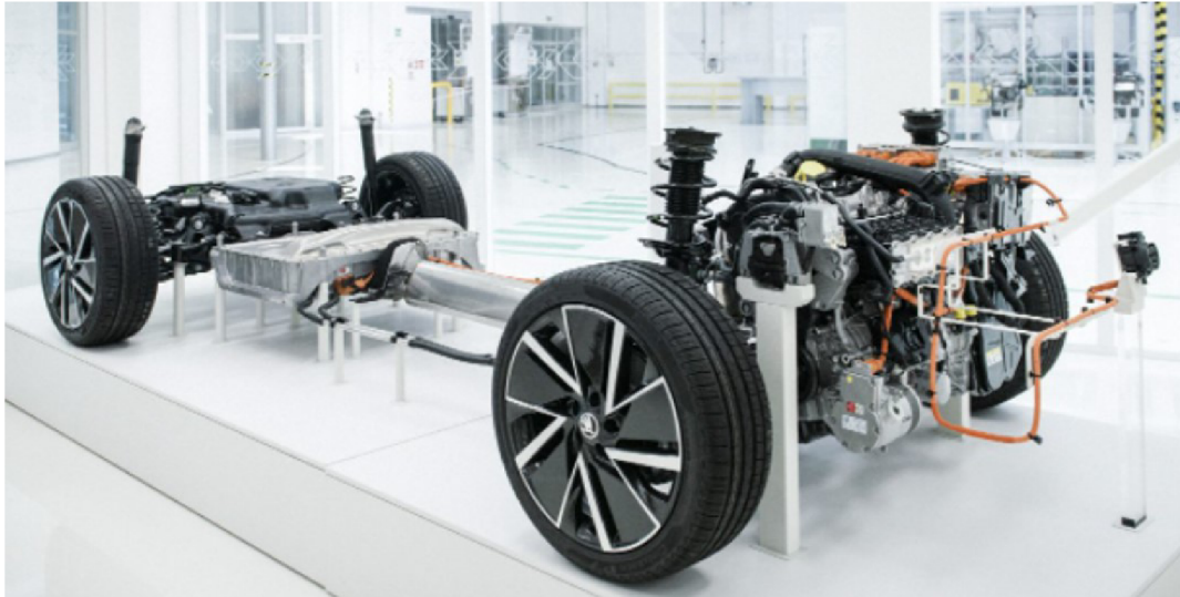
Obr. 2.6 Platforma MQB s hybridním provedením pohonu modelu Škoda Superb iV
