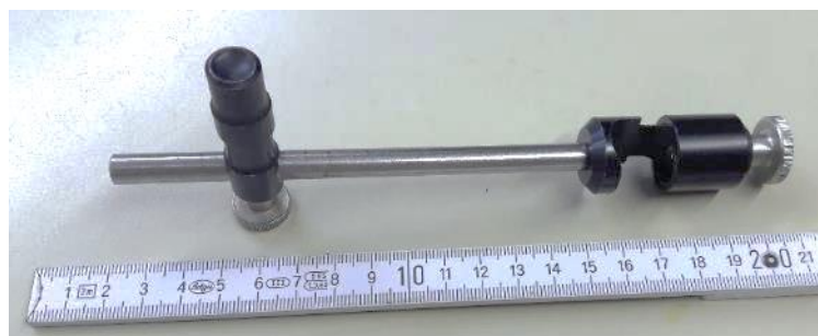
Obr. 14: Držák pro oftalmometr na měření zakřivení zadní plochy pevné kontaktní čočky
