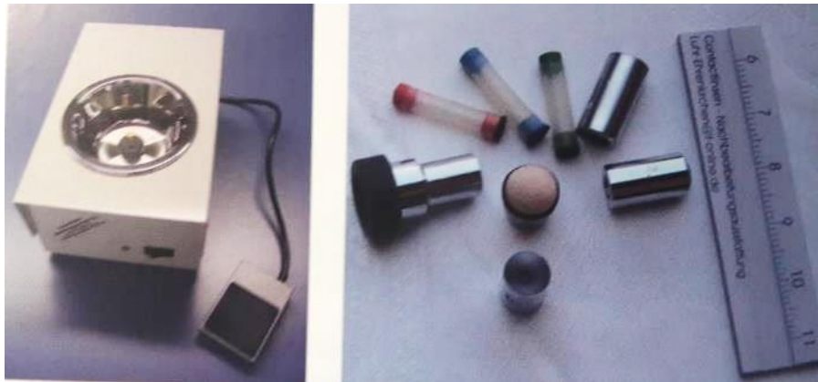
Obr. 28: Příklad přístroje pro úpravu pevných kontaktní čoček a různé kaloty pro změnu zakřivení a odstranění škrábanců [1]
