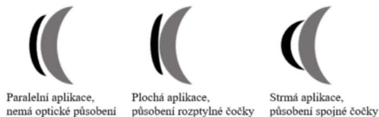
Obr. 11: Optické působení slzné čočky
