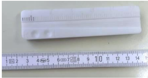
Obr. 15: V-drážka na měření průměru pevné kontaktní čočky
