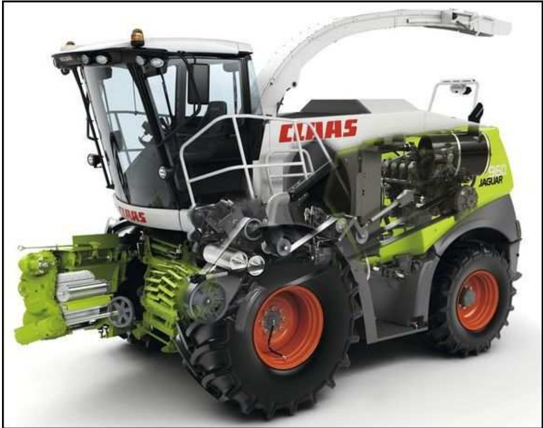
Obrázek 2. 15 Pracovní ústrojí sklízecích řezaček Claas Jaguar
