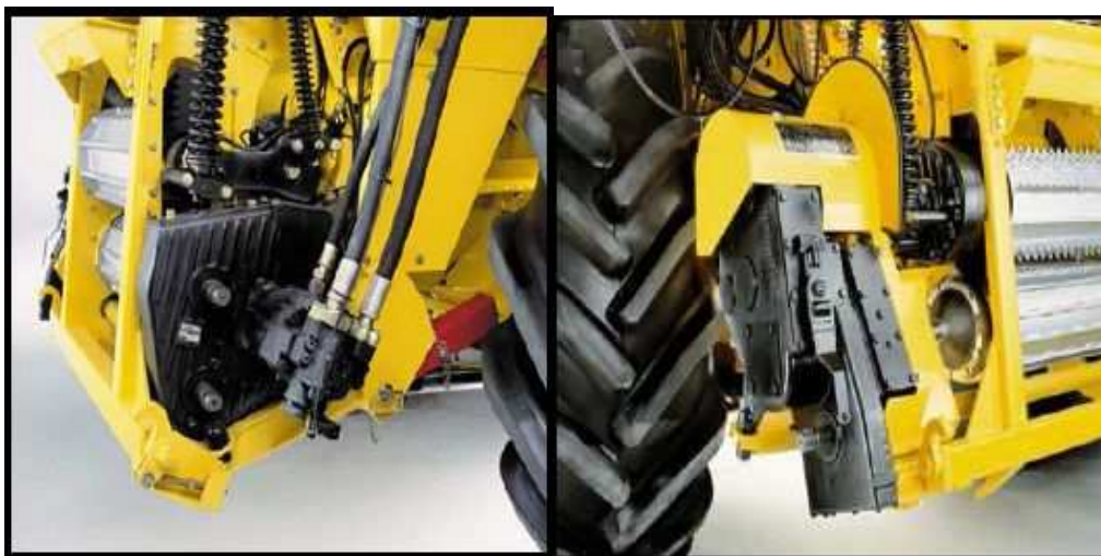
Obrázek 2.5 Hydrostatický pohon vkládacího ústrojí
